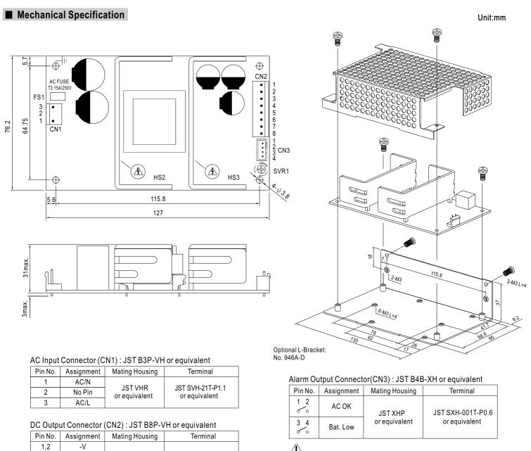
3,4 +V JST SVH-21T-P1.1 JST VHR 5,6 Bat+ or equivalent or equivalent 7,8 Bat-
